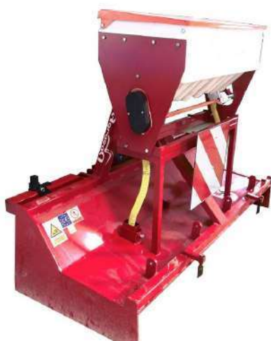
Fraise butteuse 2 rang traine a tracteur Avec Espandeuse D'engrais (Optionnel)
